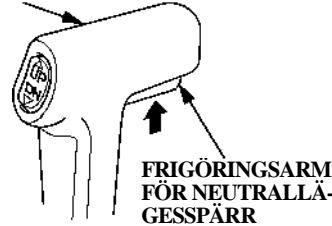
Frigöringsarm för neutrallägespärr (typ R1) FJÄRRKONTROLLSPAK
